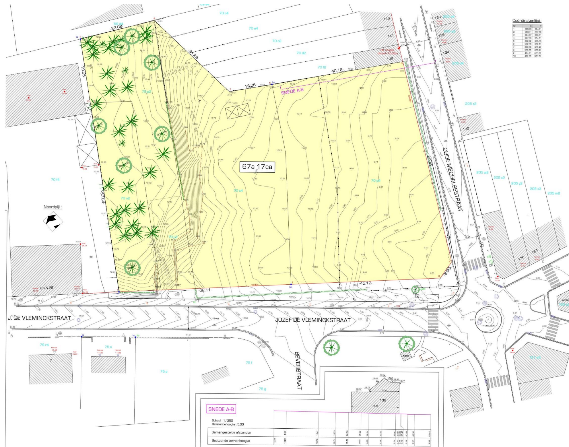
Figuur 4: Opmetingsplan bestaande toestand, met aanduiding van hoogtelijnen (Studiebureau MesO)
