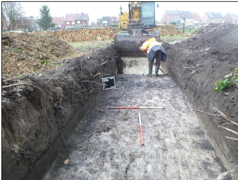
Figuur 37: Aanleg van een profielput in WP4; aanduiding van doorworteling van de bodem
