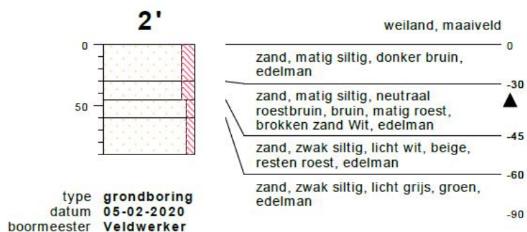
Figuur 10: Profielbeschrijving boring B2. © W. Alaerts 2020
