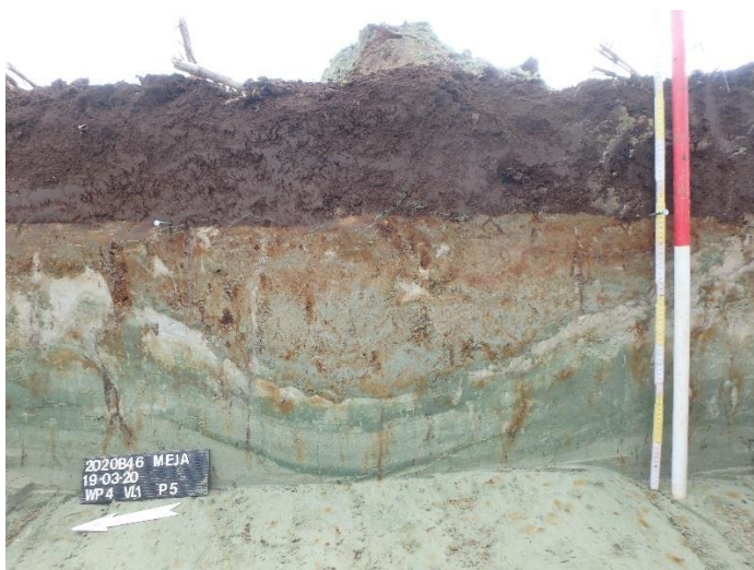
Figuur 54: P5AB toont eveneens een gecryoturbeerde moederbodem met een laag grijze klei die tot diep in de zandige C – horizont afgezet is. Tussen de C – horizont en Ap - horizont bevindt zich de overgang tussen de B en C – horizont waarin zich een grote hoeveelheid oranje roestvlekken gevormd hebben.
