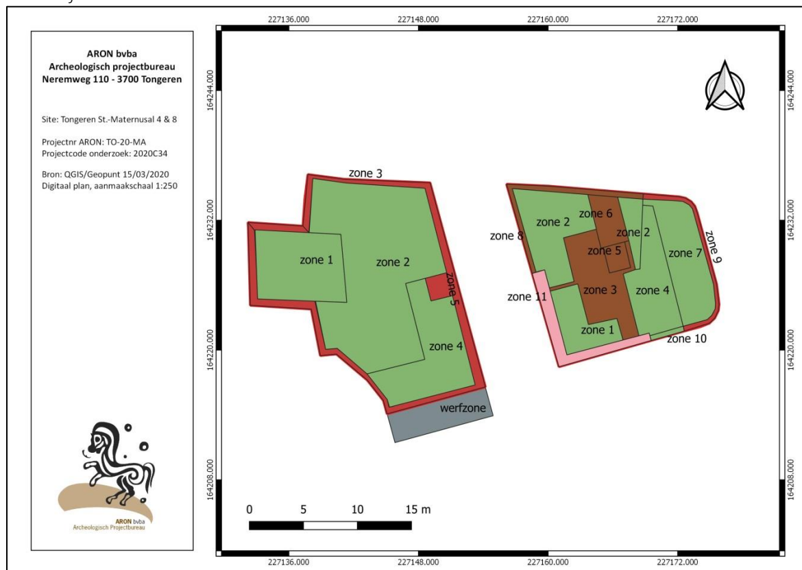
Afb. 6: Het projectgebied (rode polygoon) met aanduiding van de werfzone (grijze polygoon) en zones met geplande bodemingrepen gegroepeerd volgens impactdiepte vanaf bestaand vloerniveau: minder dan 1m diep (groene polygoon), tussen 1 en 2 m diep (rode polygoon) en tussen 3 en 5 m diep (bruine polygoon). Zone 11 (roze polygoon) is een geplande secanspalenwand waarvan de impactdiepte onbekend is.
