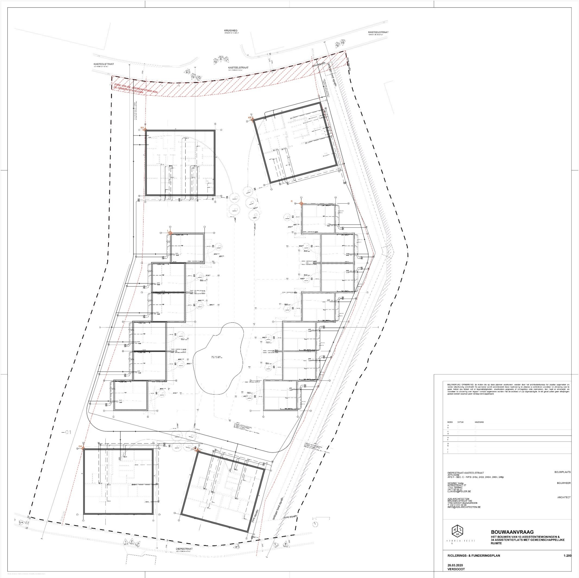
Figuur 10: Funderings- en rioleringsplan (A2S-Architecten)
