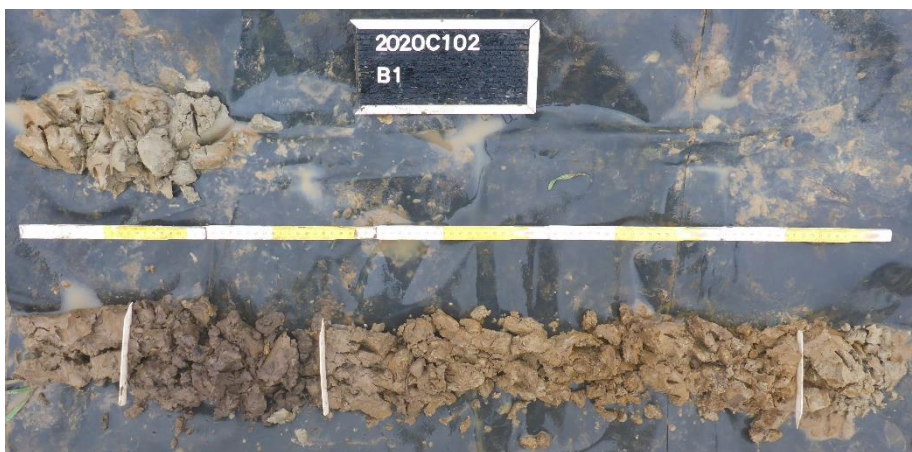
Figuur 32: Ap-C-profiel in boring B1.
