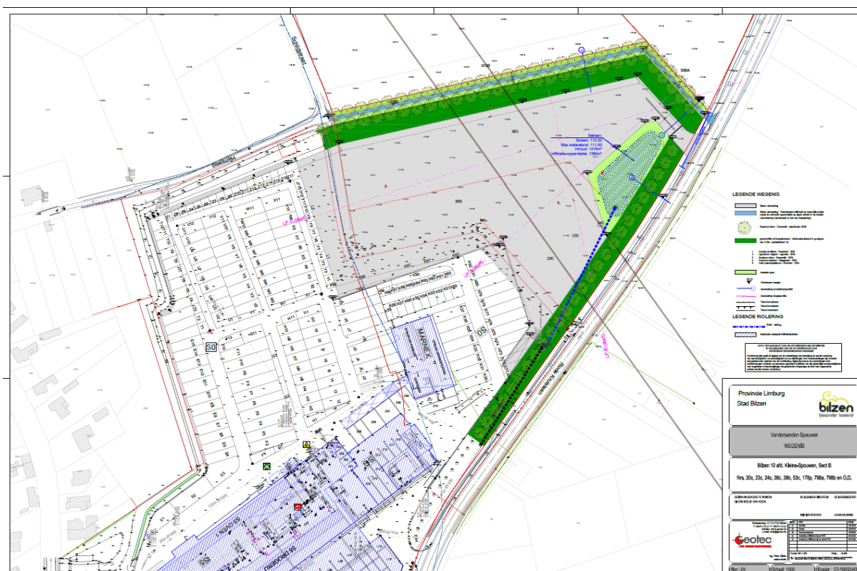
Afb. 7: Inplantingsplan ontworpen toestand (grijs: verhardingen, donkergroen: groenbuffer; donkerblauw: RWA-leiding en bufferbekken, lichtgroen: gras) (Bron: Geotec, digitaal plan, dd 10/07/2019, aanmaatschaal 1.500, 2019G160).
