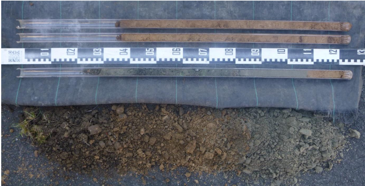
Figuur 9: Overzichtsfoto van boring BP6, uitgelegd van links naar rechts en van onder naar boven.
