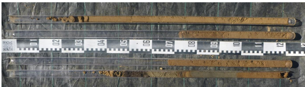
Figuur 5: Overzichtsfoto van boring BP3, uitgelegd van links naar rechts en van onder naar boven.
