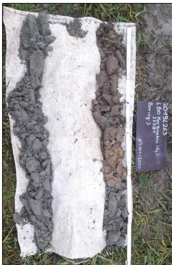
Figuur 7: Boorprofiel (links) en boorbeschrijving (rechts) van boring 3 (ABO nv 2020)
