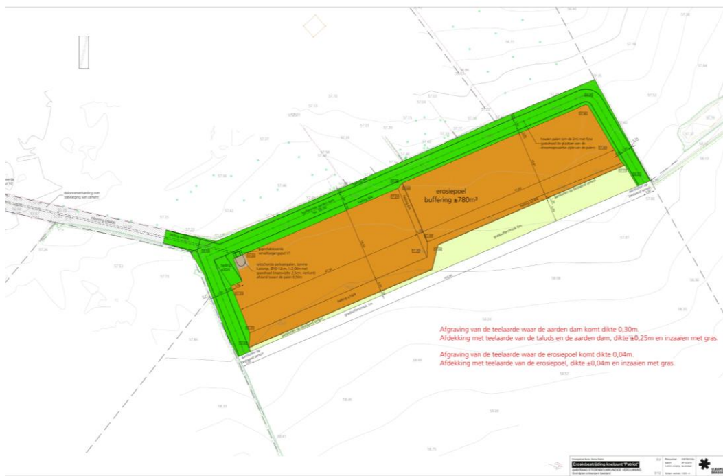
Afb. 7. Nieuw plan voor de erosiebestrijding. Groen = dam, oranje = erosiepoel en geel = grasbufferstrook.
