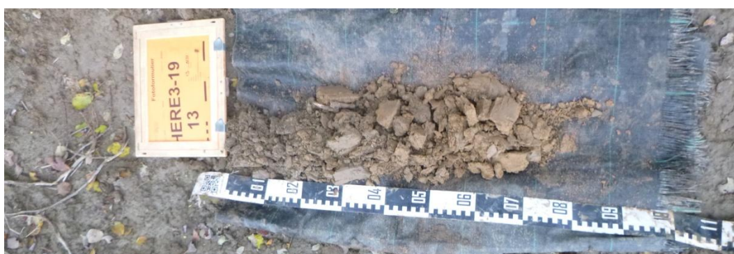
Afb. 17. Foto van boring 13, uitgelegd van links naar rechts. 0-20 centimeter: pakket Ap; 20-40 centimeter: pakket Ap2; 40-75 centimeter: pakket Cg.
