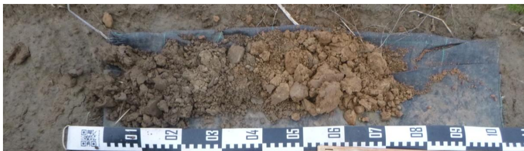
Afb. 13. Foto van boring 1, uitgelegd van links naar rechts. 0-25 centimeter: pakket Ap; 25-30 centimeter: pakket E; 30-40 centimeter: pakket Bh; 40-75 centimeter: pakket Cg.
