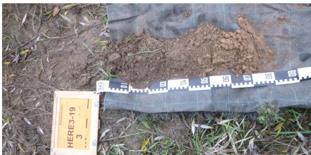
Afb. 15. Foto van boring 3, uitgelegd van links naar rechts. 0-30 centimeter: pakket Ap; 30-50 centimeter: pakket E/B; 50-75 centimeter: pakket Cg.
