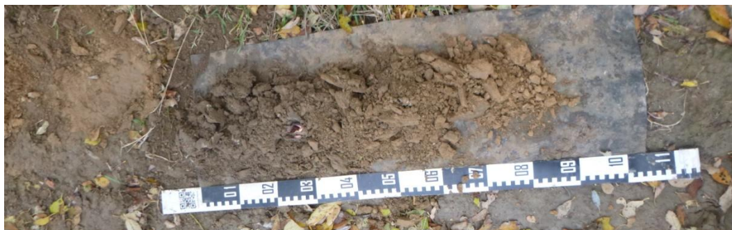
Afb. 16. Foto van boring 6, uitgelegd van links naar rechts. 0-40 centimeter: pakket Ap; 40-75 centimeter: pakket A/C; 75-80 centimeter: pakket Cg.
