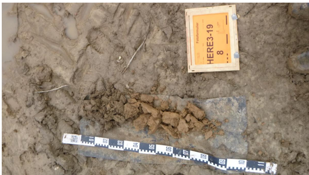
Afb. 14. Foto van boring 8, uitgelegd van links naar rechts. 0-20 centimeter: pakket Ap; 20-40 centimeter: pakket Bh; 40-80 centimeter: pakket Cg.
