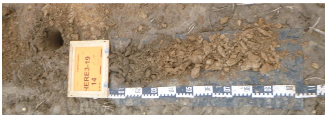
Afb. 18. Foto van boring 14, uitgelegd van links naar rechts. 0-35 centimeter: pakket Ap; 35-60 centimeter: pakket Cg; 60-90 centimeter: pakket Cg.
