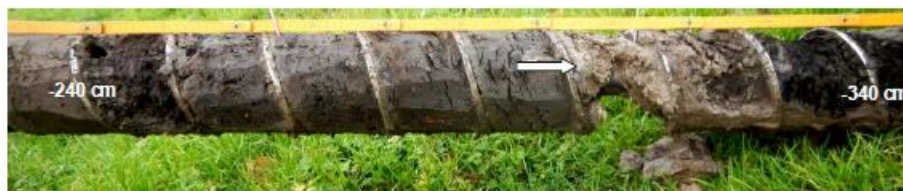
Figuur 20: Gedeelte van boring 13.1 met sublaag binnen laag 3 met hoge concentratie kalkgruis en slakkenhuisjes (VEC, 2020).
