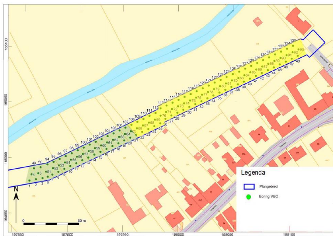
Figuur 4: Geplande boorpuntenkaarten. Het oostelijke/centrale deel (hellingvoet) is geel gekleurd; het westelijke deel (randzone = beekdal) is groen ingekleurd (VEC, 2020).
