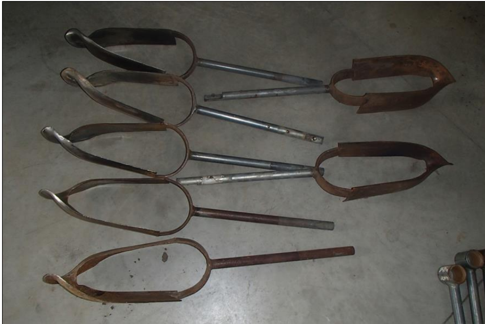
Figuur 35: Voorbeeld Edelmanboor met diameter van 15 cm (©BAAC)
