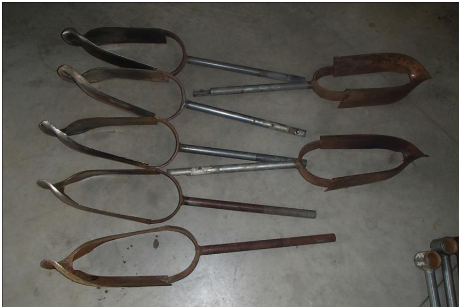
Figuur 29: Voorbeeld Edelmanboor met diameter van 15 cm
