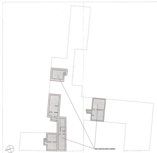
Figuur 6: Voormalige kelderverdiepingen ter hoogte van het klooster.
