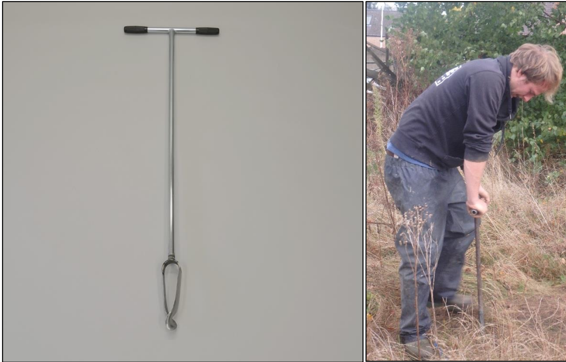
Figuur 9: Links: Edelmanboor (combiboor) met een diameter van 7 cm (Bron: http://www.eijkelpark.com ); Rechts: uitvoering van een landschappelijke boring met een Edelmanboor (Foto door J. Overmeire, 19-10-2016)
