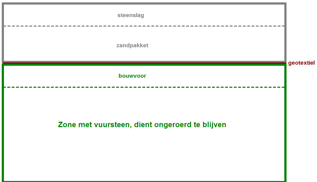
Afb. 3. Schematische weergave van de toe te passen behoud in situ maatregel ter hoogte van het terrein voor grondverbetering
