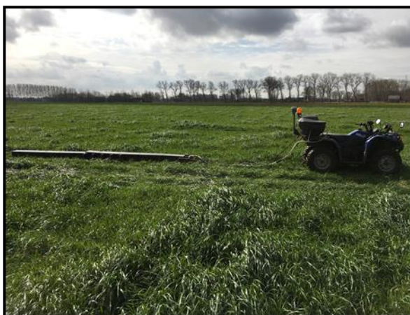
Figuur 5 : mobiele sensorconfiguratie met de EMI sensor in de slede en RTK-GPS.
