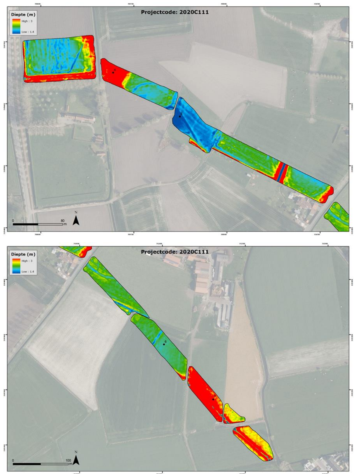
Figuur 49 : Voorgestelde boorlocaties geplot op een kaart van de voorspelde diepte van het zand onder de klei in zones 1, 2 en 3.
