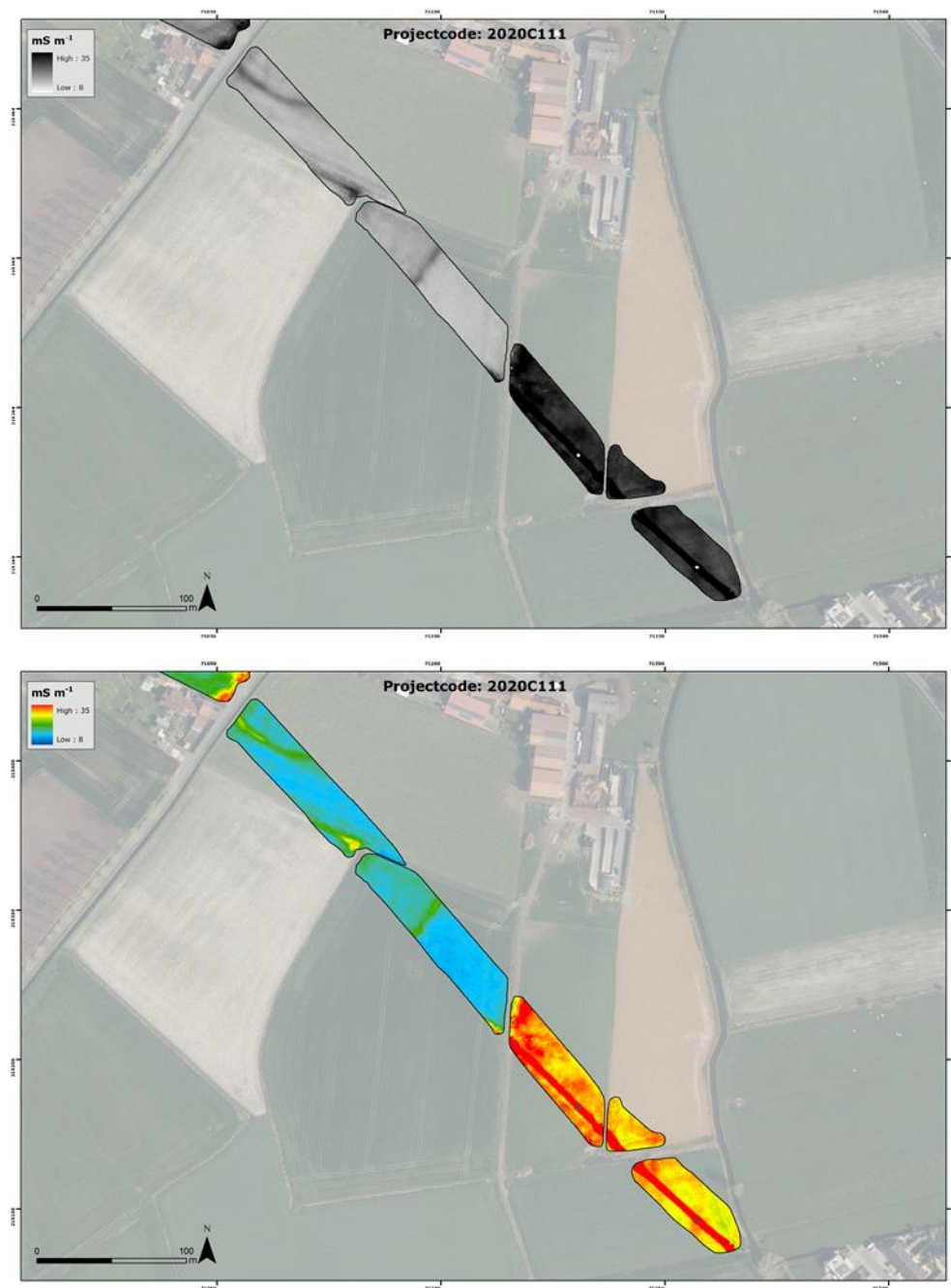
Figuur 11 : EG opgemeten met de 2PRP spoelconfiguratie (dominante respons tussen 0 en 1.0 m diepte) in zone 3.
