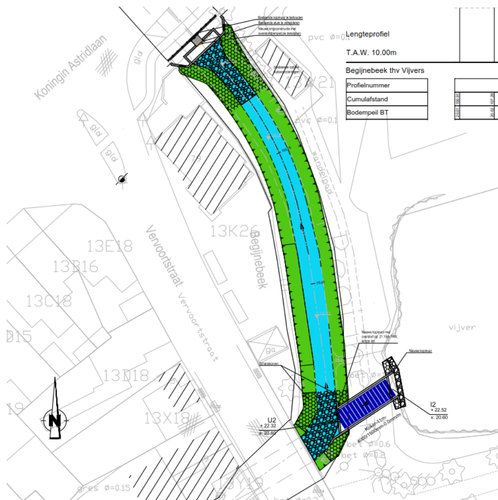
Figuur 15: Inplanting inlaatconstructie (overstortdrempel) vanuit de Begijnebeek naar de nabijgelegen vijver provinciaal domein de Halve Maan, situering ondergrondse schuif t.h.v. Koningin Astridlaan en herprofilering tussenliggend traject Begijnebeek (bron: uitsnede voorontwerp, Sweco).
