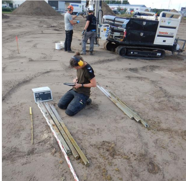
Figuur 6. Mechanische landschappelijke boringen met liners.
