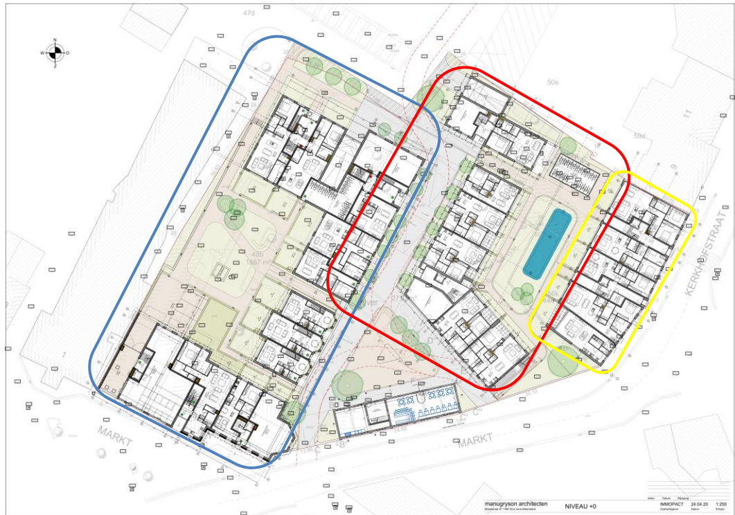
Afb. 8. Detailafbeelding van de nieuwbouw gelijkvloers met aanduiding van de fasering (fase 1 blauw – fase 2 rood – fase 3 geel).
