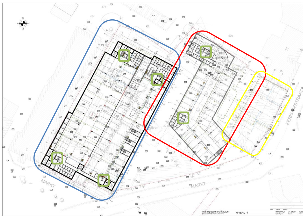
Afb. 7. Detailplan van de ondergrondse garage met aanduiding van de twee fasen (fase 1 blauw, fase 2 rood), liften (groen) en fase 3 (geel).
