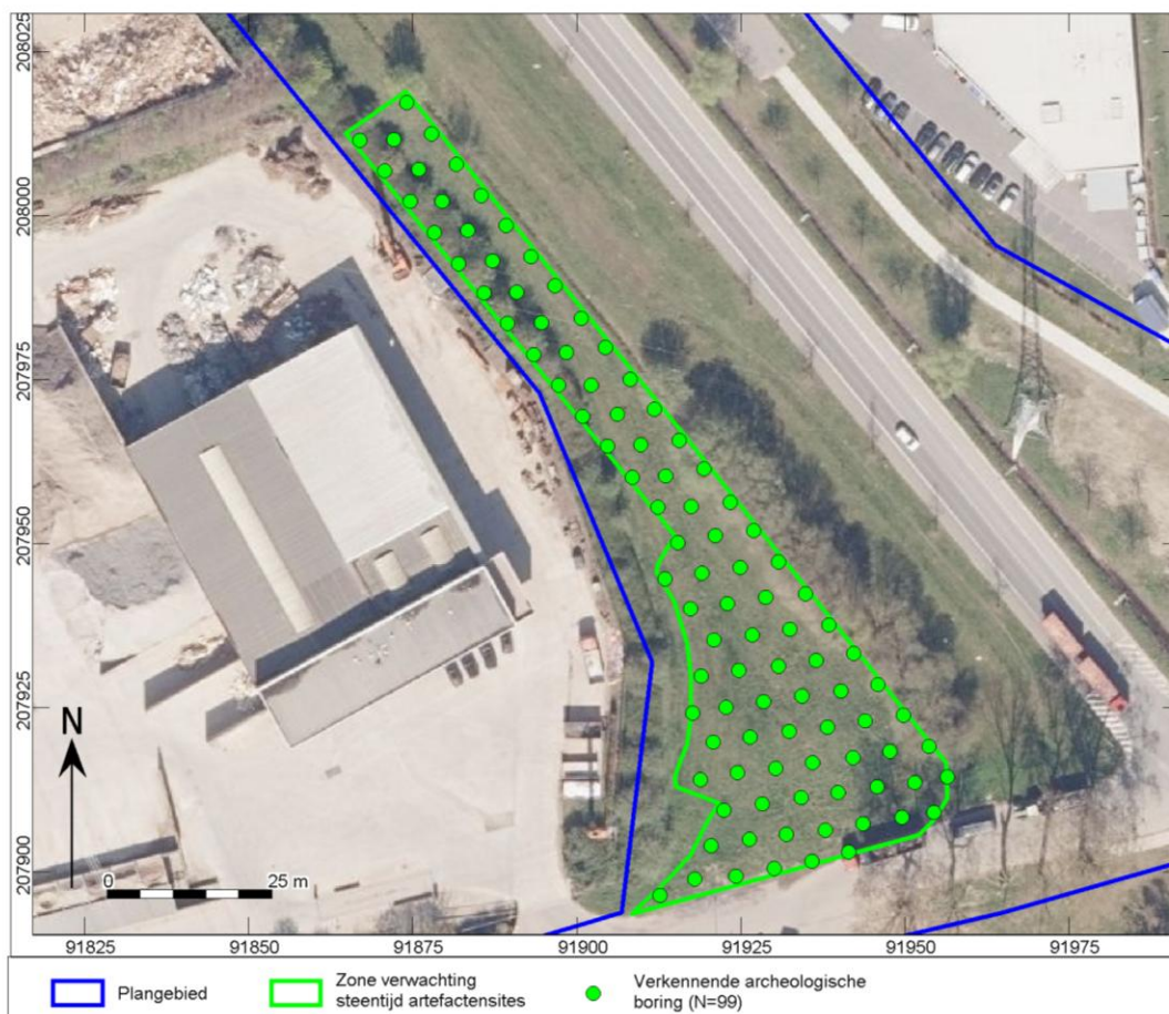
Afb. 13. Indicatief boorpuntenplan voor een verkennend archeologisch booronderzoek in 6 x 5 m grid (boorafstand x raaiafstand), weergegeven op een luchtfoto uit 2019.
