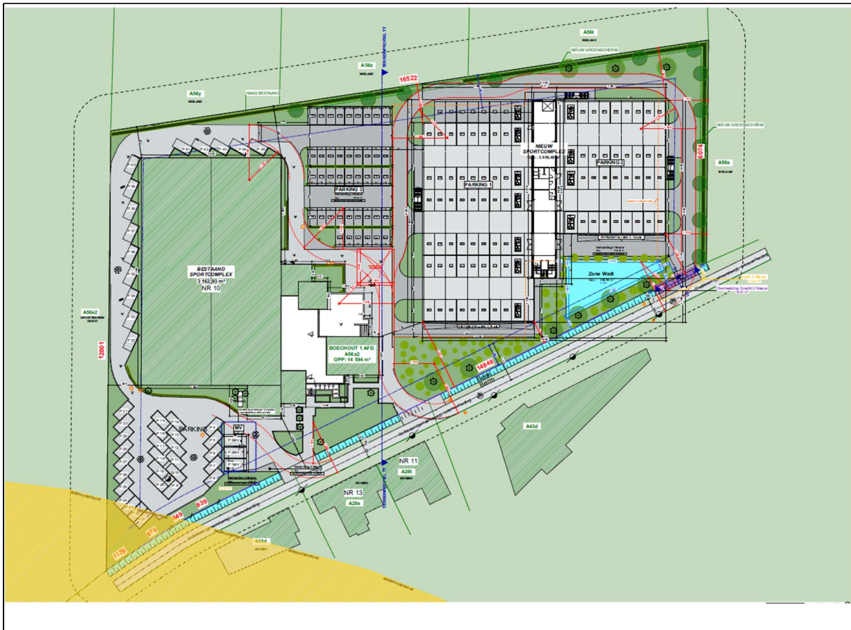
Figuur 3a. Inplantingsplan met aanduiding van de te behouden structuren (sportcomplex met bijhorende verhardingen) en de nieuwbouw (noorden bevindt zich aan de linkerkant van de afbeelding).
