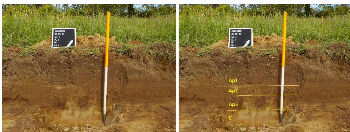
Figuur 8. Overzicht van de bodemopbouw in profiel 1. ©LARES
