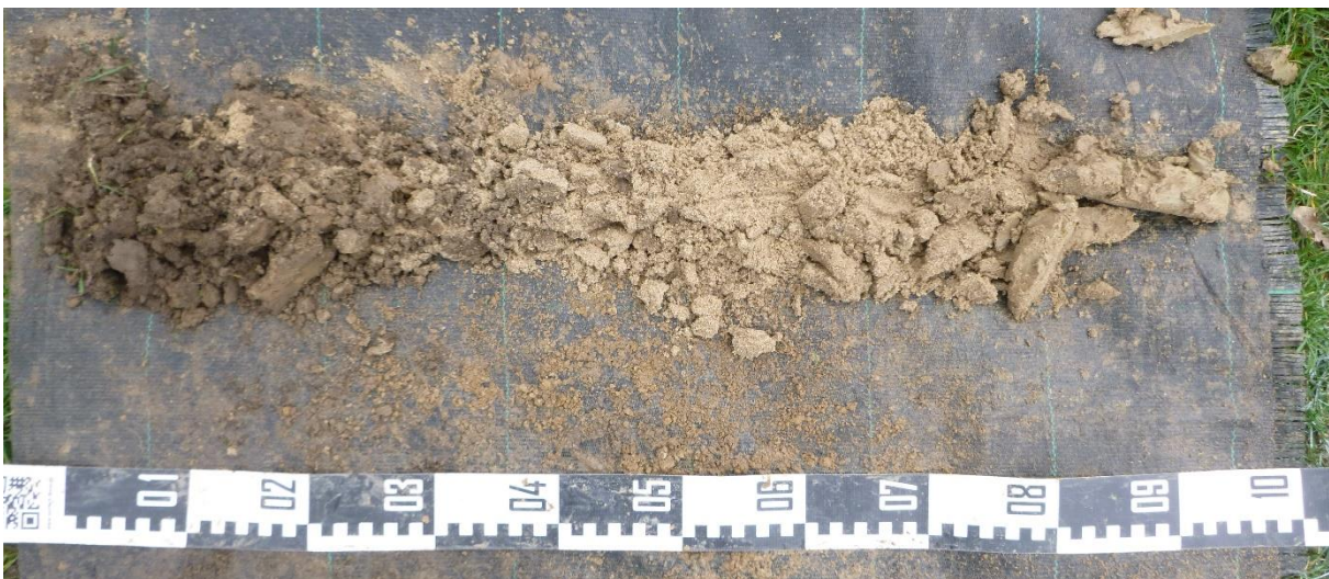
Figuur 8: Overzichtsfoto van boring BP3, uitgelegd van links naar rechts.
