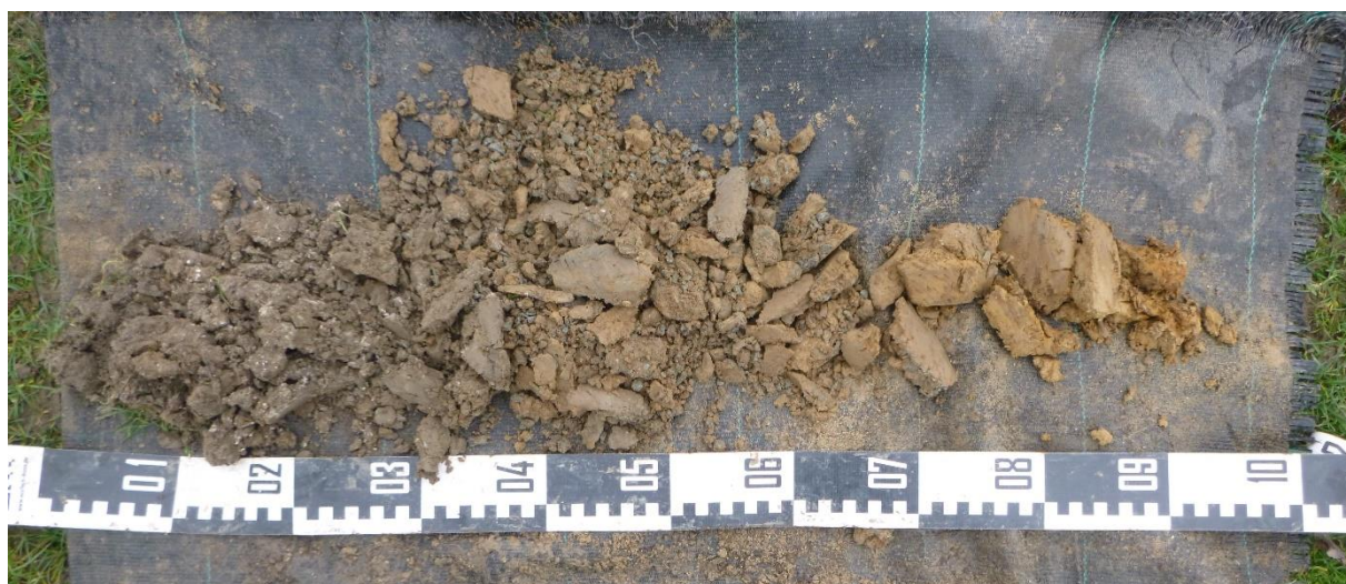
Figuur 9: Overzichtsfoto van boring BP8, uitgelegd van links naar rechts.
