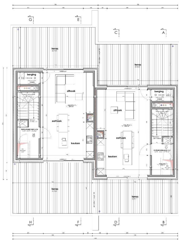
VERDIEPING 2 BLOK A schaal 1:50
