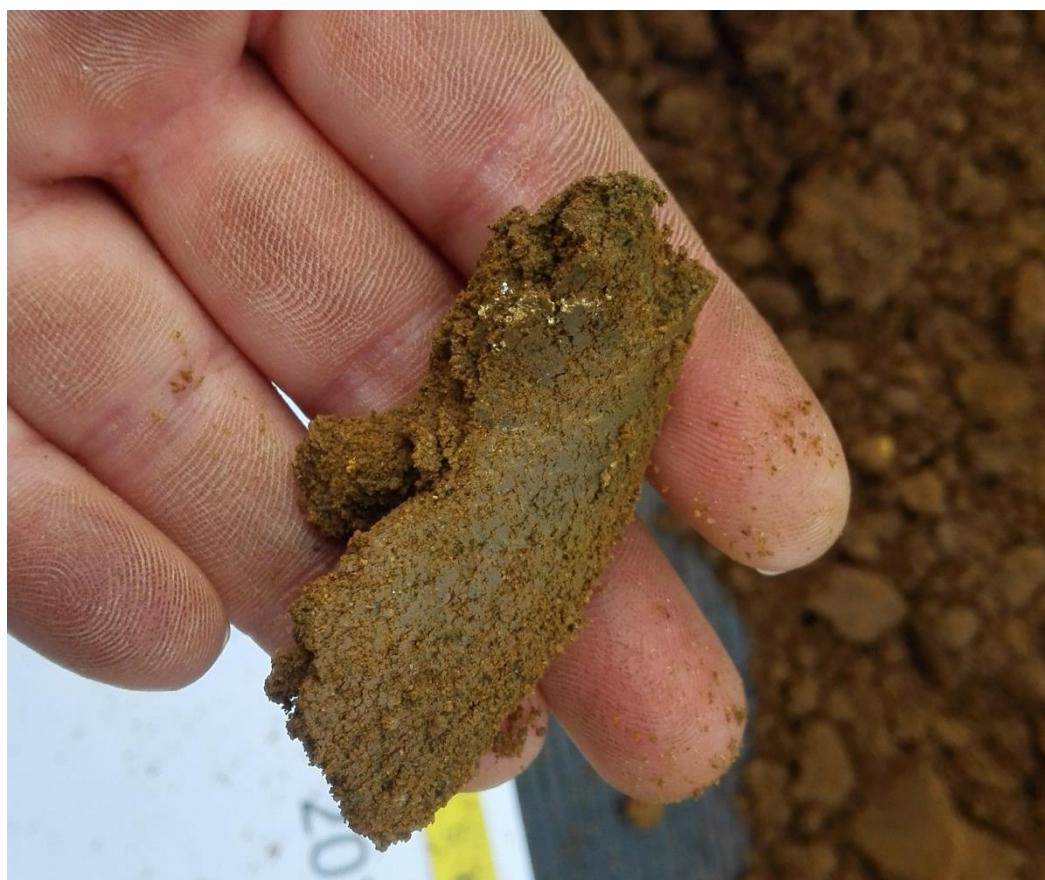
Figuur 14: Detailfoto van de kleiige kalkhoudende tertiaire laag (boring 3).
