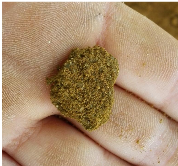
Figuur 12: Detailfoto van een brok aangevoerd gestabiliseerd zand dat is vermengd met kalkhoudend tertiair zand (boring 2).
