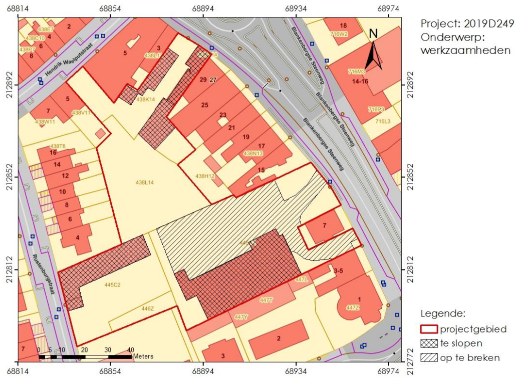
Figuur 6: sloop- en afbraakwerken op het projectgebied weergegeven op het GRB-bestand (©Geopunt)
