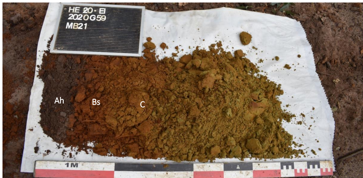
Afb. 28: Referentieprofiel MB 21 met horizonten Ah – Bs – C (Bron: Aron bv, dd. 07/07/2020, 2020G59).
