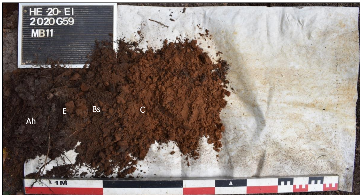
Afb. 27: Referentieprofiel MB 11 met horizonten Ah – E – Bs – C (Bron: Aron bv, dd. 07/07/2020, 2020G59).
