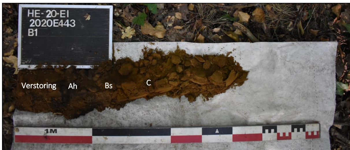
Afb. 13: Referentieprofiel B1 met aanduiding van de horizonten Verstoring – Ah – Bs – C (Bron: Aron bv, dd. 02/06/2020, 2020E443).
