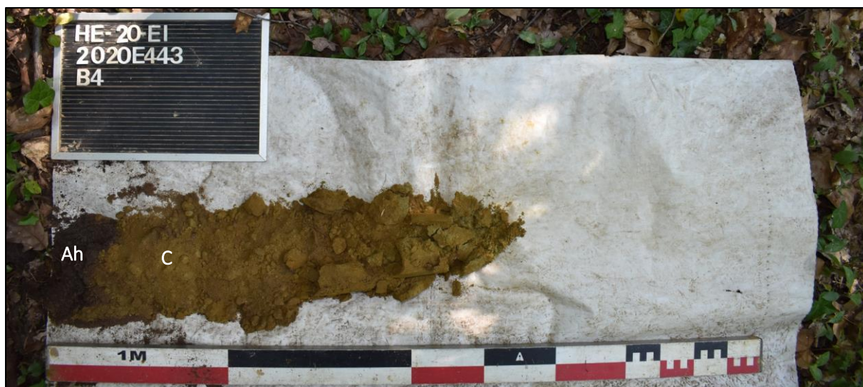
Afb. 16: Referentieprofiel B4 met aanduiding van de horizonten Ah – C (Bron: Aron bv, dd. 02/06/2020, 2020E443).
