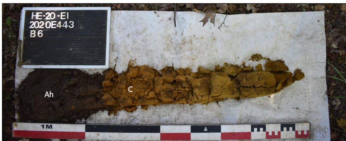
Afb. 18: Referentieprofiel B6 met aanduiding van de horizonten Ah – C (Bron: Aron bv, dd. 02/06/2020, 2020E443).
