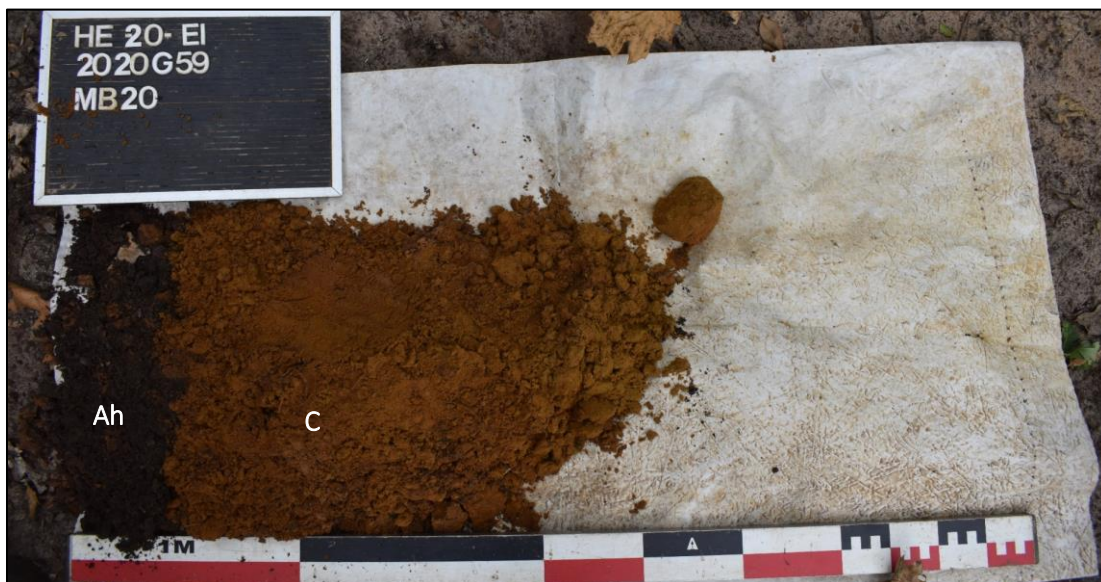
Afb. 31: Referentieprofiel MB 20 met horizonten Ah – C (Bron: Aron bv, dd. 07/07/2020, 2020G59).
