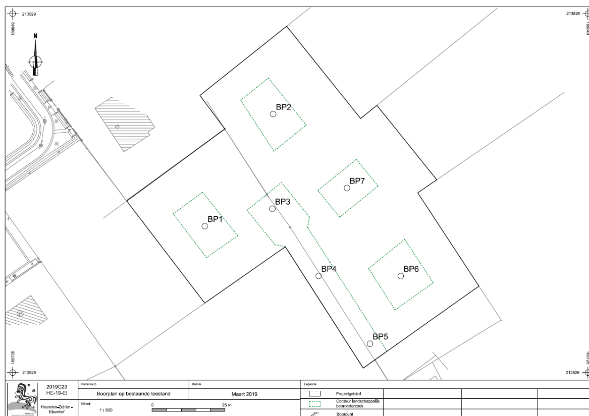
Afb. 11: Boorplan met aanduiding van de boorpunten en het onderzoeksterrein (groene streepjeslijn) op bestaande toestand (BT) (Bron: Aron bvba, digitaal plan, dd. 06/03/2019, aanmaatschaal 1.500, 2020E443).
