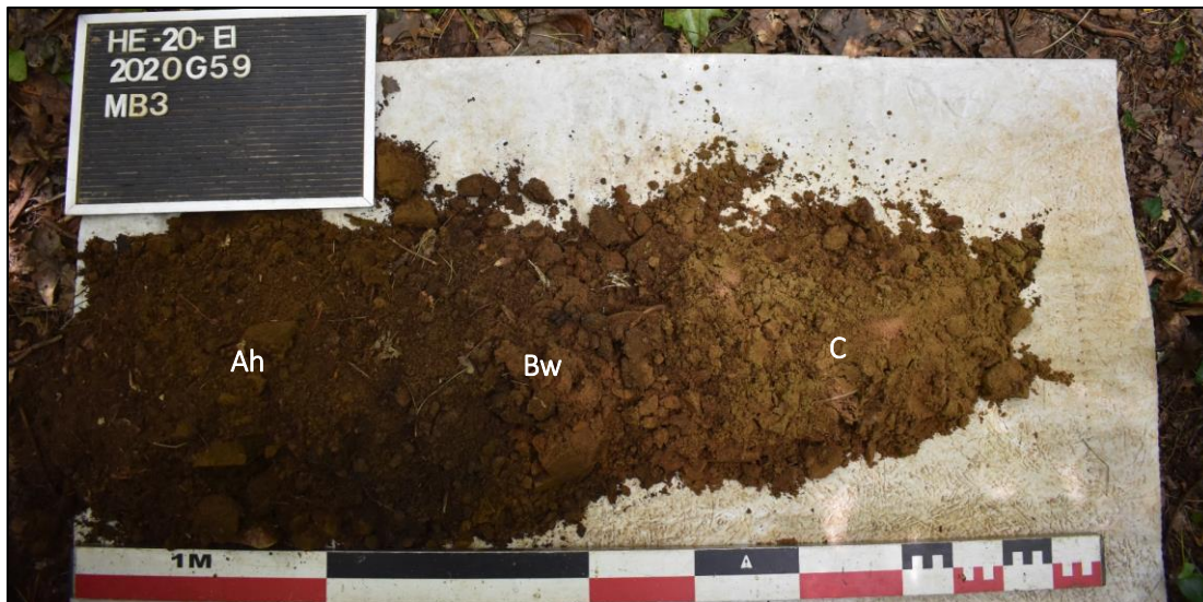
Afb. 30: Referentieprofiel MB3 met horizonten Ah – Bw – C (Bron: Aron bv, dd. 07/07/2020, 2020G59).
