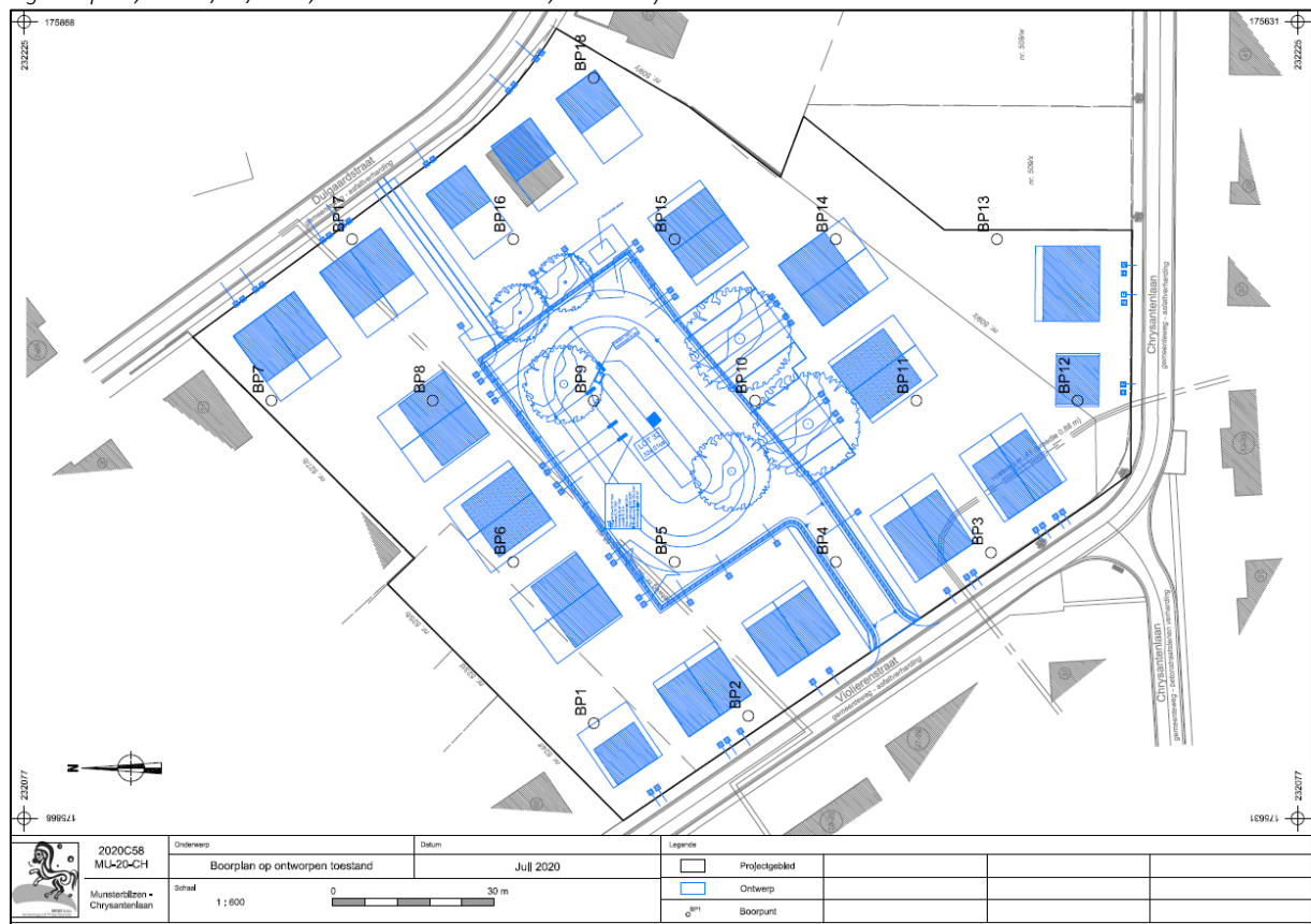
Afb. 31: Boorplan met aanduiding van de boorpunten op het projectgebied (zwart) op bestaande toestand (BT) (Bron: Aron bv, digitaal plan, dd. 14/07/2020, aanmaakschaal 1.600, 2020C58).
