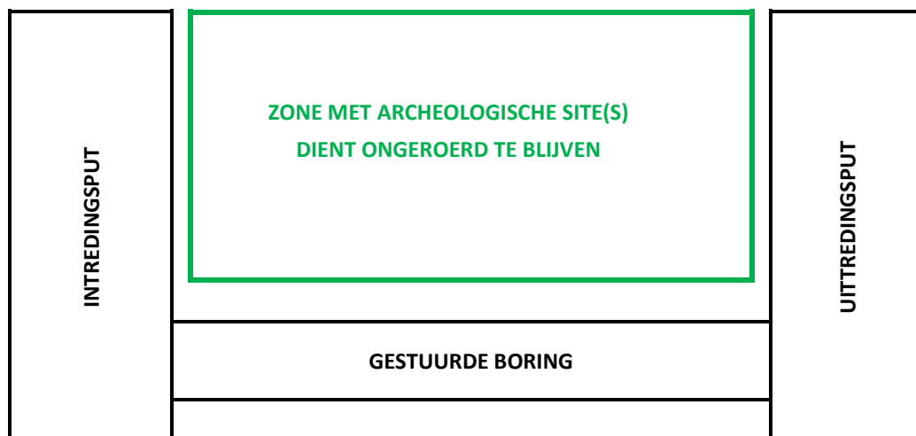
Afb. 7. Schematische weergave van de toe te passen behoud in situ maatregel ter hoogte van de archeologische sites
