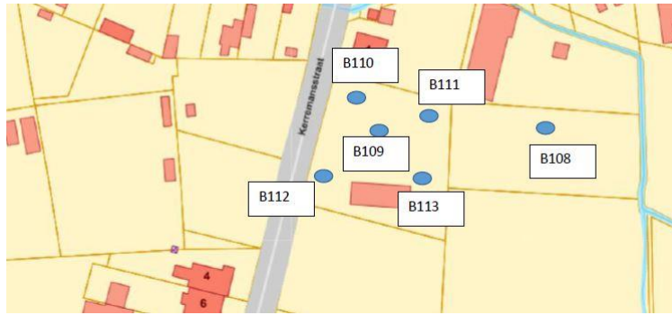
Figuur 18: boringen binnen het bufferbekken (ABO nv 2020).
