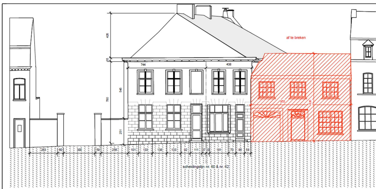
Figuur 5. Aanduiding van de te slopen structuren.
