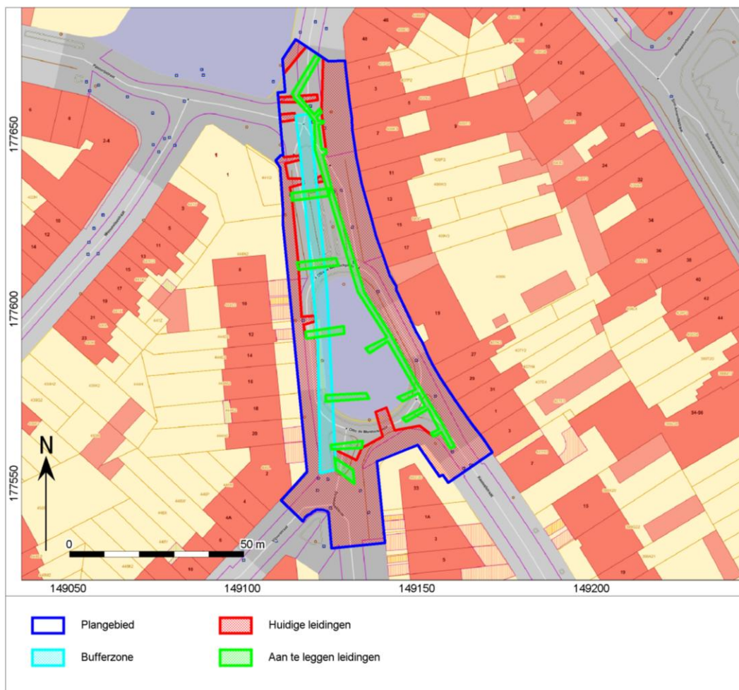
Afb. 1. Zones met een bedreiging voor eventueel aanwezige intacte archeologische niveau (de bufferzone en de aan te leggen leidingen). De locaties van de huidige aanwezige leidingen, die dit niveau al hebben verstoord, zijn ook aangeduid.
