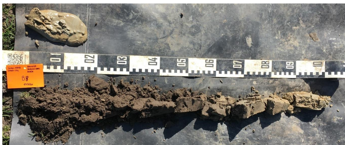
Figuur 30 : Boring 8 van 0 (linksonder) naar 120 cm (linksboven) beneden het maaiveld.
