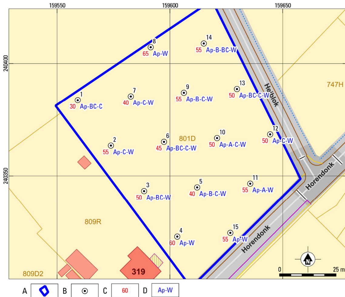
Fig. 2.3. Essen-Over d'Aa (22.606U). Diepte van bouwvoor en verploegde laag in het onderzoeksgebied, en aangetroffen stratigrafie in het onderzoeksgebied.
