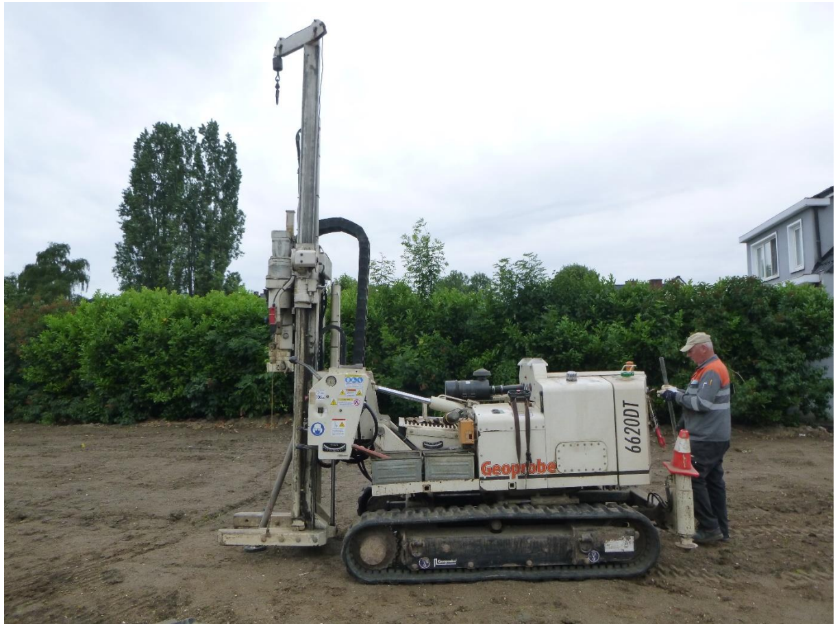
Figuur 30: Zijaanzicht van de Geoprobe boormachine, gebruikt om boring BP5 uit te voeren.
