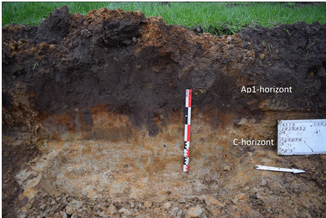
Figuur 8: profiel 5 in sleuf 6 aan de zuidzijde van het projectgebied met een recente bouwvoor direct op de C-horizont die hier bestaat uit klei met veel roestvlekken.
