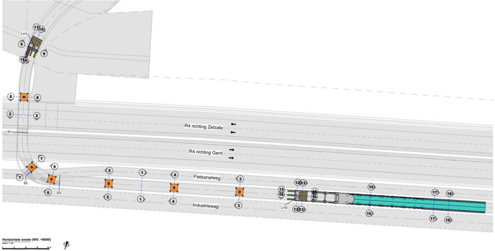
Figuur 8: Horizontaledoorsnede van de fietsbrug met aanduiding van de pijlers en landhoofden en onderstaande doorsnedes 11
