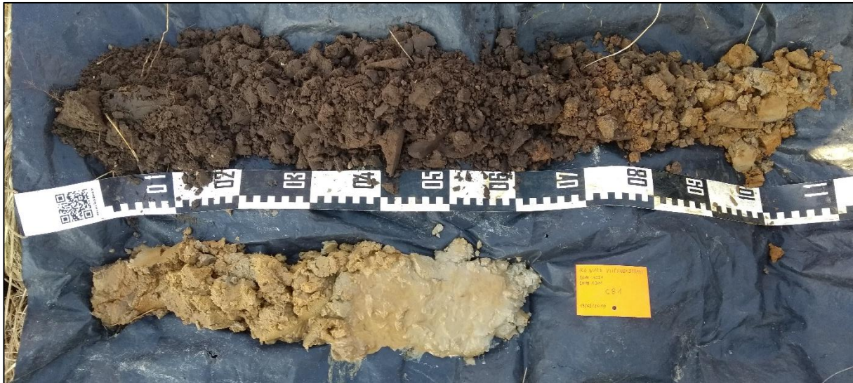
Figuur 25 : Boring 1, van 0 cm (linksboven) tot 160 cm (rechtsonder).
