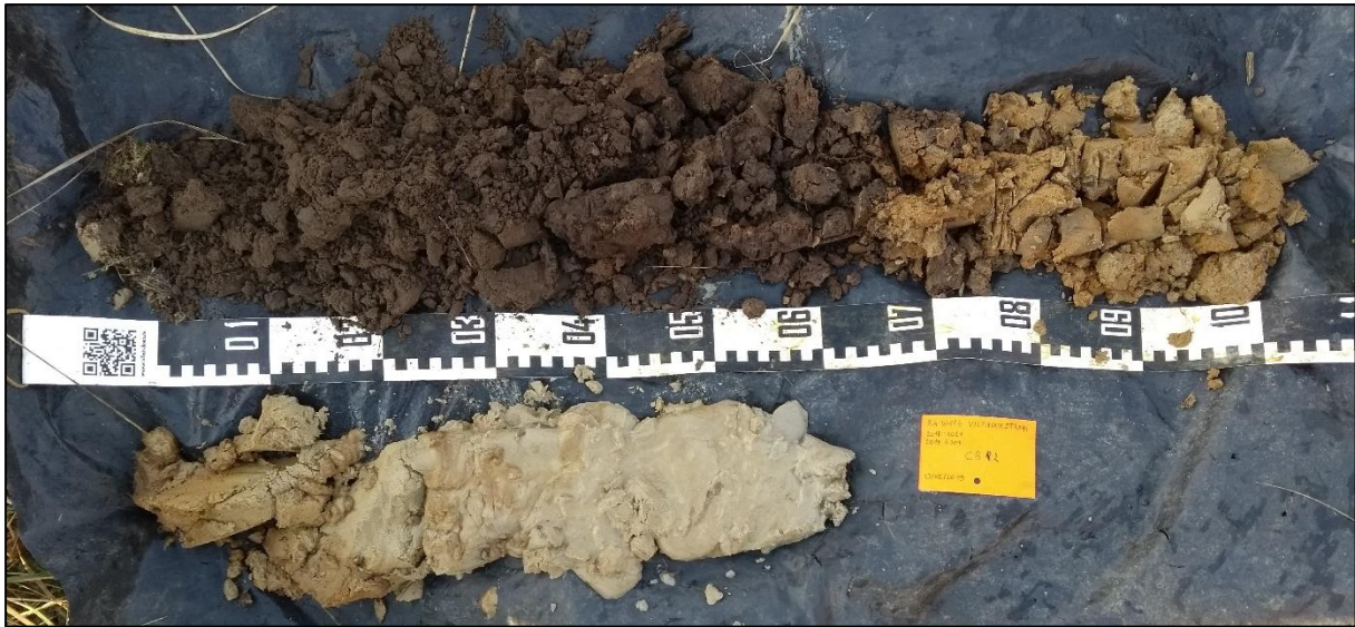
Figuur 26 : Boring 2, van 0 cm (linksboven) tot 160 cm (rechtsonder).
