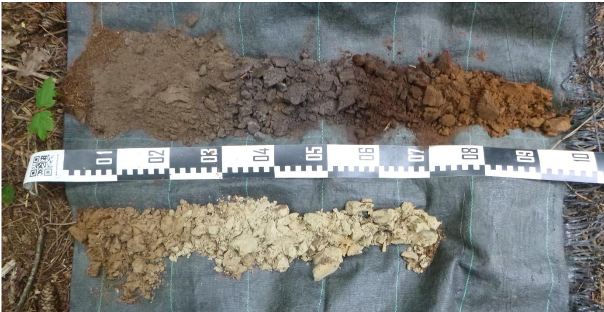
Figuur 7: Weergave van boring BP5, uitgelegd van links naar rechts en van boven naar onder.
