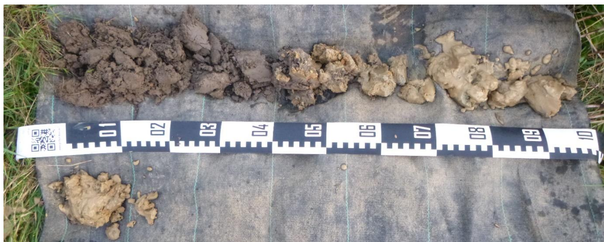
Figuur 9: Overzichtsfoto van boring BP4, uitgelegd van links naar rechts en van boven naar onder. Deze foto is representatief voor boringen BP4, BP5 en BP6.
