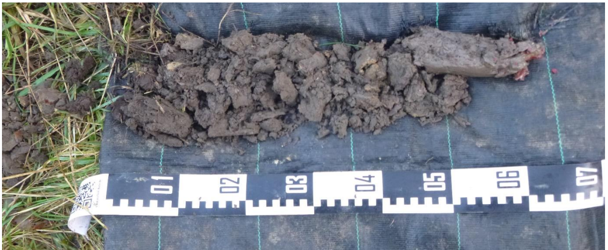
Figuur 7: Overzichtsfoto van boring BP8, uitgelegd van links naar rechts.
