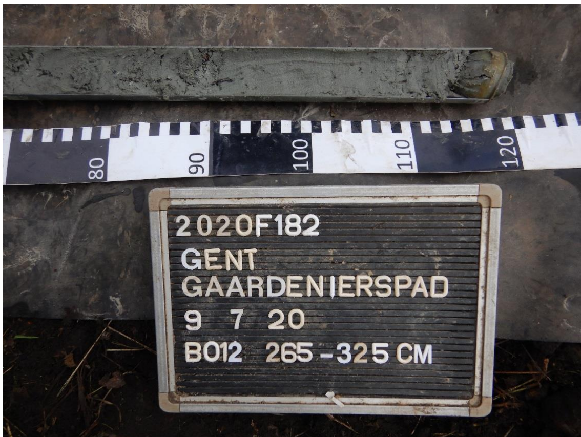
Figuur 11: Detail van boorprofiel 12 met een fijne gelaagdheid in de alluviale zandlaag (C-horizont)
