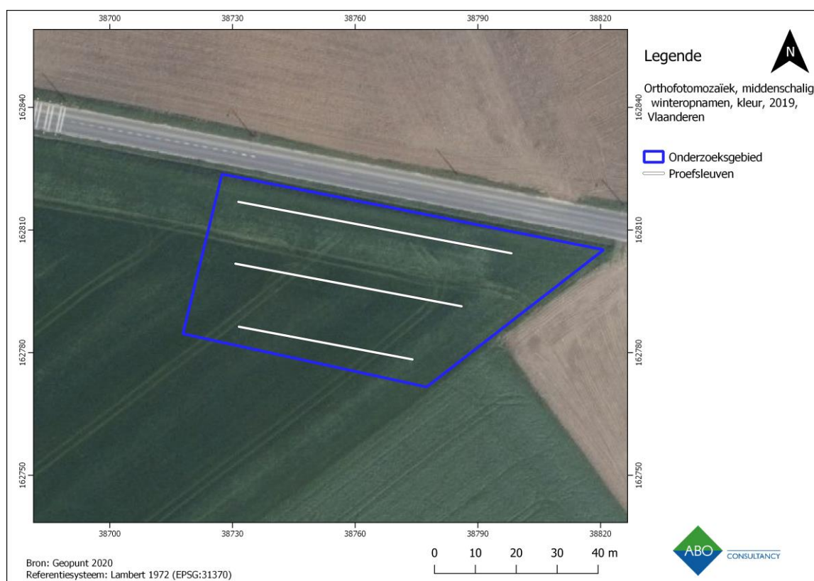
Figuur 4: Luchtfoto (middenschallige winteropnamen, kleur, 2019) met aanduiding van het indicatieve proefsleuvenplan binnen het terrein voor grondverbetering.
