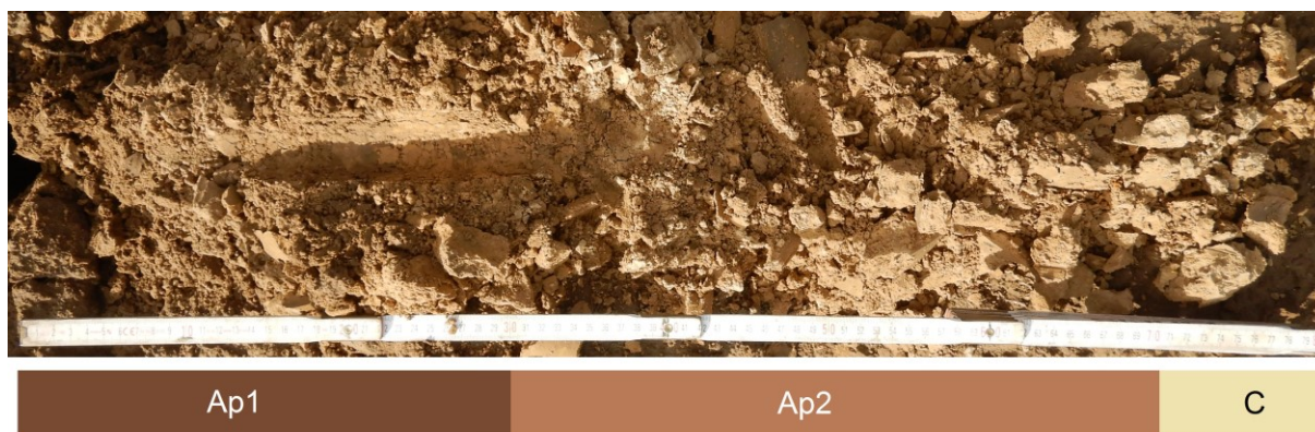
Fig. 2. Foto en schematische voorstelling van de bodemopbouw van boorpunt 5.
