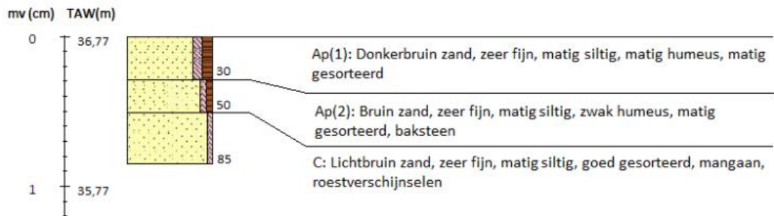
Figuur 21: Boorstaat boring 5 (Archebo bvba, 2020)
