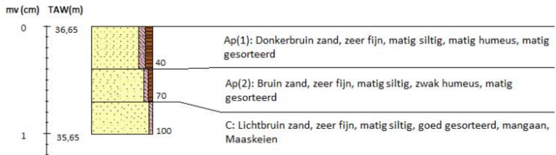
Figuur 17: Boorstaat boring 3 (Archebo bvba, 2020)
