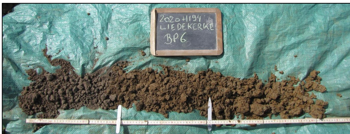
Figuur 14 Zicht op boorprofiel 6 met een verstoord bodemprofiel.
