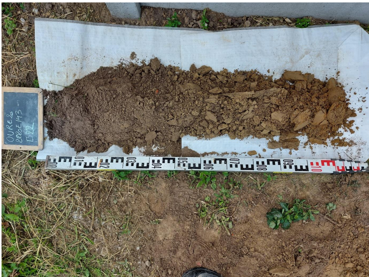
Figuur 4: Voorbeeld van een boring (boring B22) zoals geregistreerd op het terrein.
