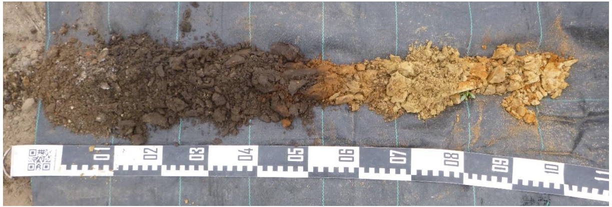
Figuur 7: Overzichtsfoto van boring BP5, uitgelegd van links naar rechts.
