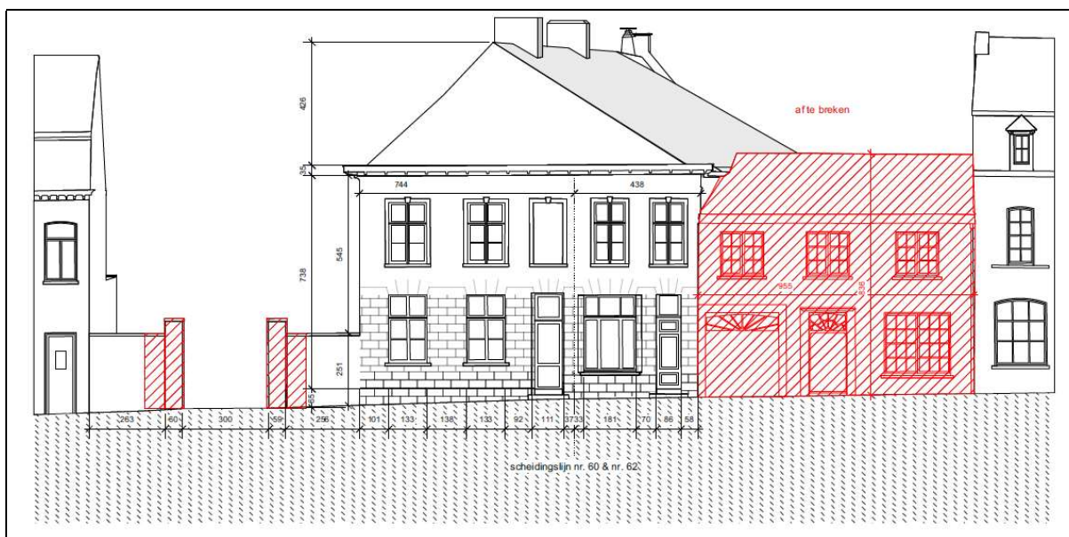
Figuur 5. Aanduiding van de te slopen structuren.
