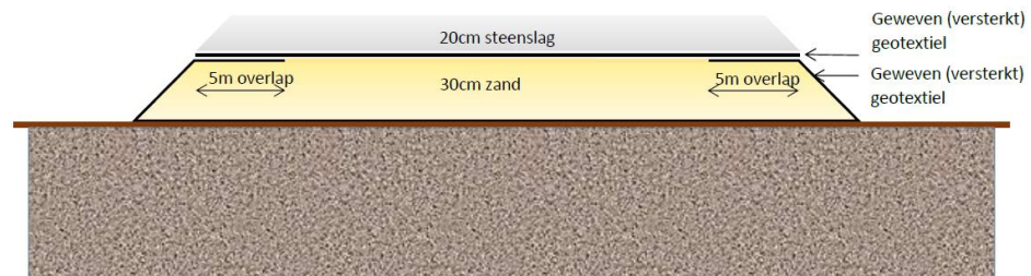
Figuur 2: Figuur die de opbouw voor terrein voor grondverbetering weergeeft. Zoals duidelijk wordt dit volledig in opbouw aangelegd waardoor geen verstoringen in de bodem zullen plaatsvinden.
