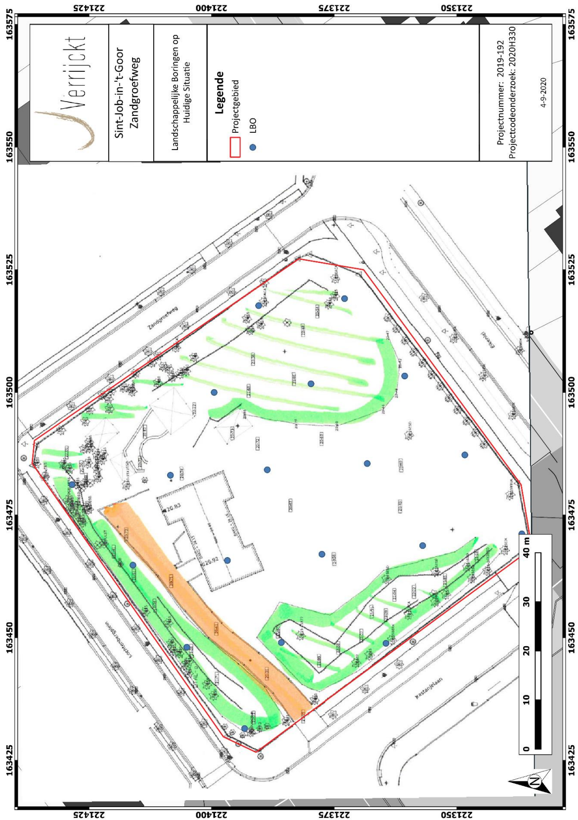
Figuur 5: Landschappelijke boringen met aanduiding van de taluds (groen)
