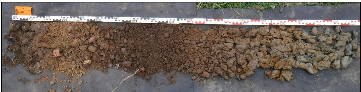
Figuur 13: VAB 40 van 0 cm links tot 200 cm rechts, met een puinig ophogingspakket van ca. 60 cm.
